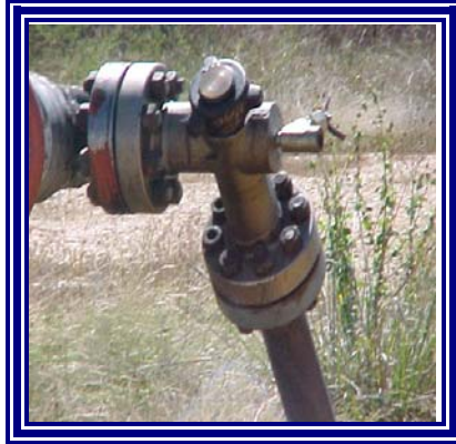
Figura 2.4 Fotografía de un estrangulador conectado al cabezal de pozo.
