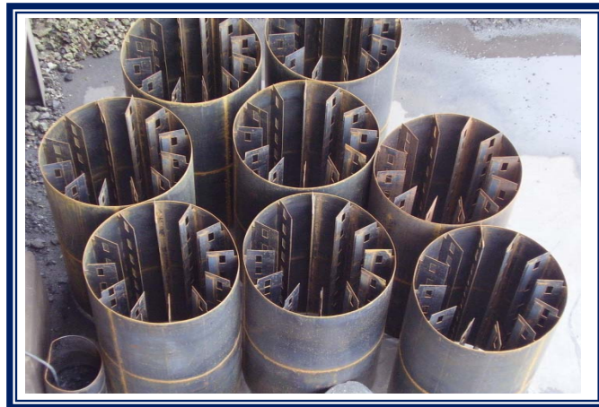
Figura 2. 14 Envoltura de un electrodo de auto-cocción, mostrando sus aletas de acero
