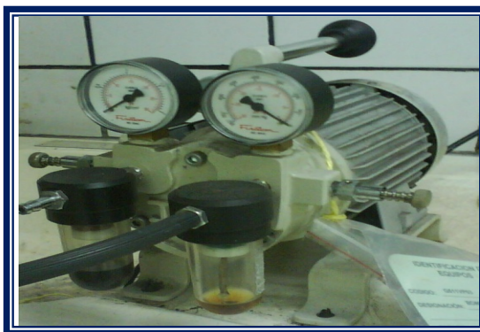
Figura 3.14 Bomba de vacío
