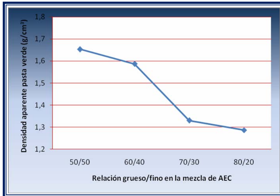
Figura 4.5 Densidad aparente promedio de la pasta eléctrica fabricada a diferentes relaciones grueso/fino en la mezcla de AEC
