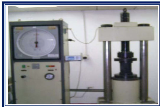
Figura 3.10 Prensa hidráulica para ensayos mecánicos
