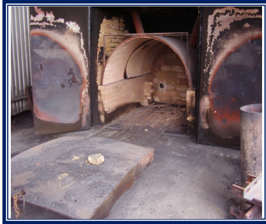
Figura 3.11 Horno para cocción de probetas de pasta electrónica
