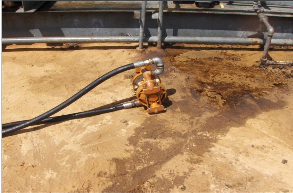
**Figura 4. 1.** Bomba portátil empleada para suministrar químicos al sistema de agua de cada unidad motocompresora
