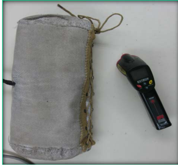
Figura 4. 11. Sistema empleado para elevar y medir la temperatura de las muestras de gas a ser analizadas
