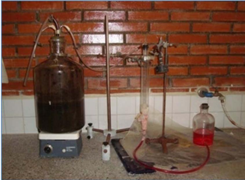
**Figura 3.1. Reactor anaeróbico y dispositivo de medición de biogás utilizado**
