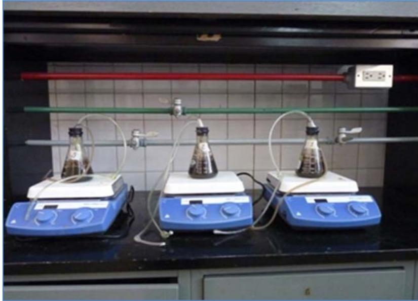
**Figura B.5 Reactores anaeróbicos utilizados para la evaluación de los parámetros de control en la biodegradabilidad de los extractos de yuca amarga**
