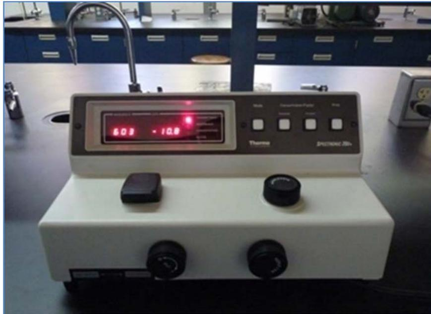
**Figura B.7 Vista frontal del Espectrofotómetro empleado para la medición de absorbancia.**
