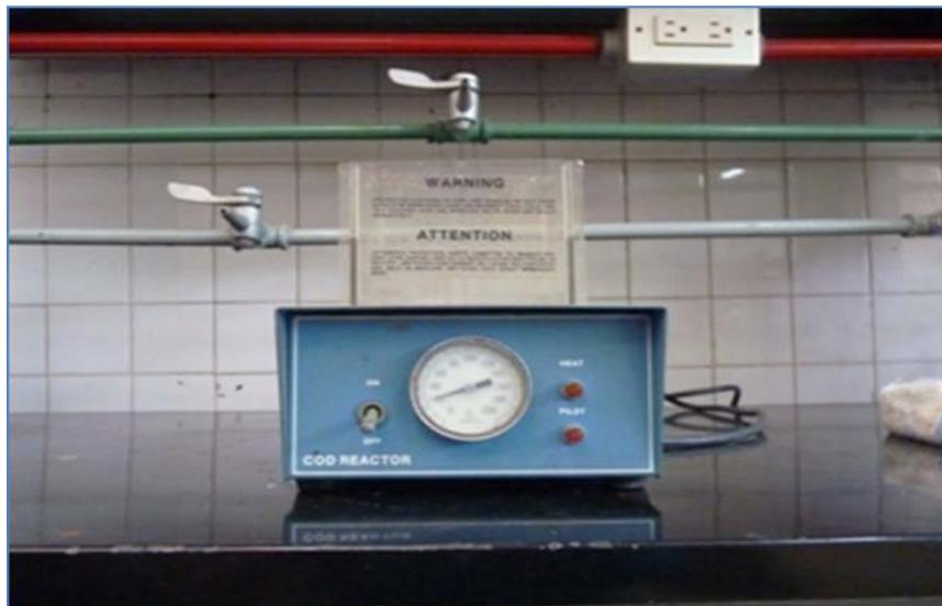
**Figura B.6 Vista frontal del termo reactor para el tiempo de reacción de la DQO**
