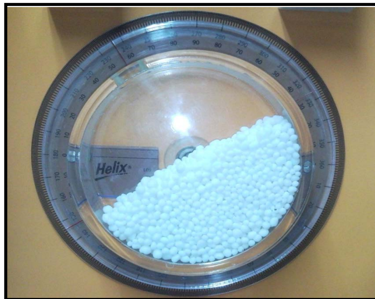
Figura 4.7. Cilindro de medición de ángulo de reposo con urea.
