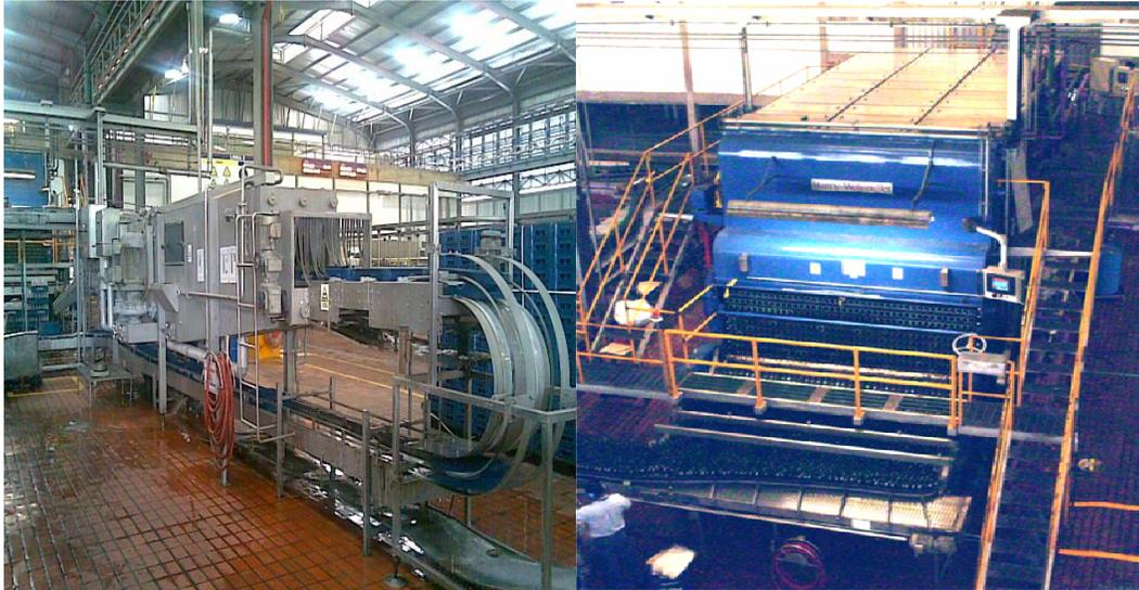
Figura 2.3. Lavadora de cajas y lavadora de botellas
