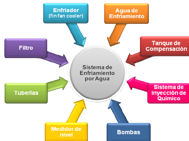
Figura 3. 2. Equipos y accesorios del sistema de enfriamiento, utilizados para el análisis de criticidad
