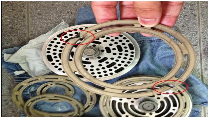
**Figura 4.1 Anillo obturador fracturado de la válvula de descarga del compresor 15-K-001C**
