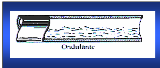
Figura Nro. 2 Patrón de flujo ondulante.
