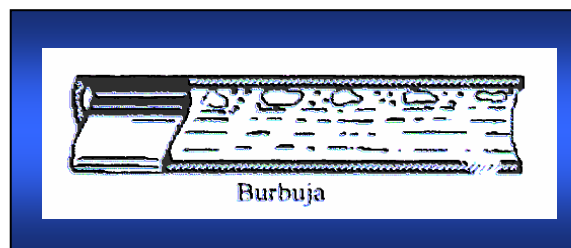
Figura Nro. 7 Patrón de flujo burbuja
