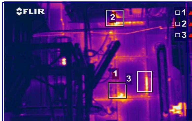
**Figura 4.5 Prueba termográfica realizada a la caldera.**
