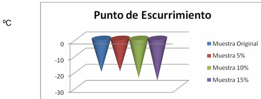
Figura 4.14 Variación del Punto de Escurrimiento con respecto a la concentración de biodiesel en aceite lubricante.
