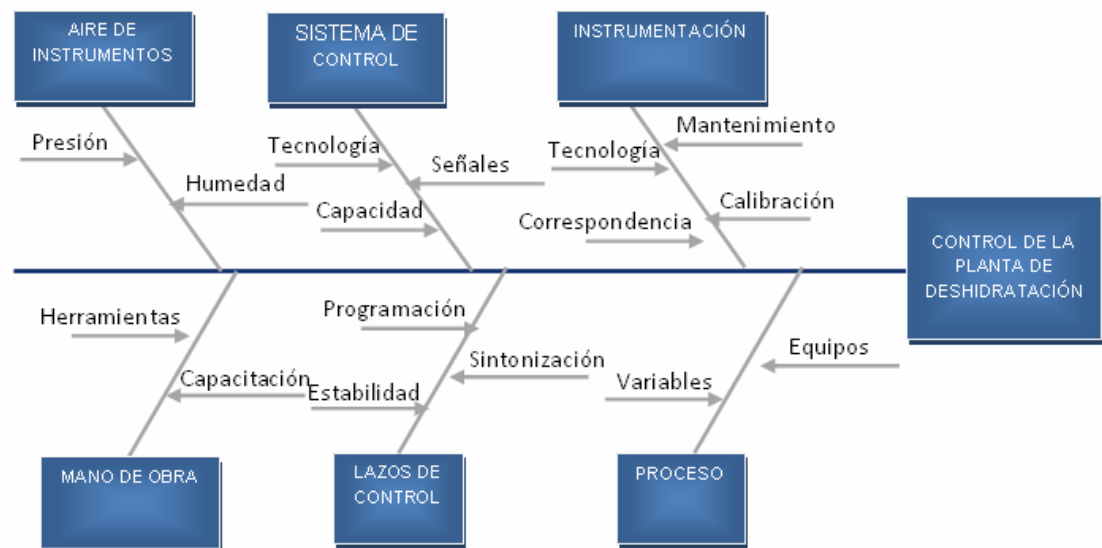
Figura 4.19. Diagrama análisis causa-efecto de la filosofía de control.
