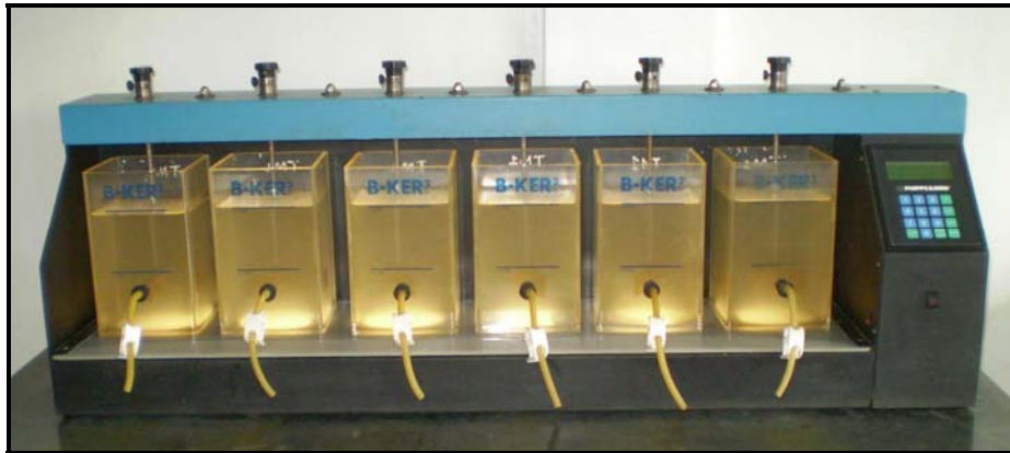
Figura 2. 9 Equipo de prueba de jarras Phipps & Bird.
