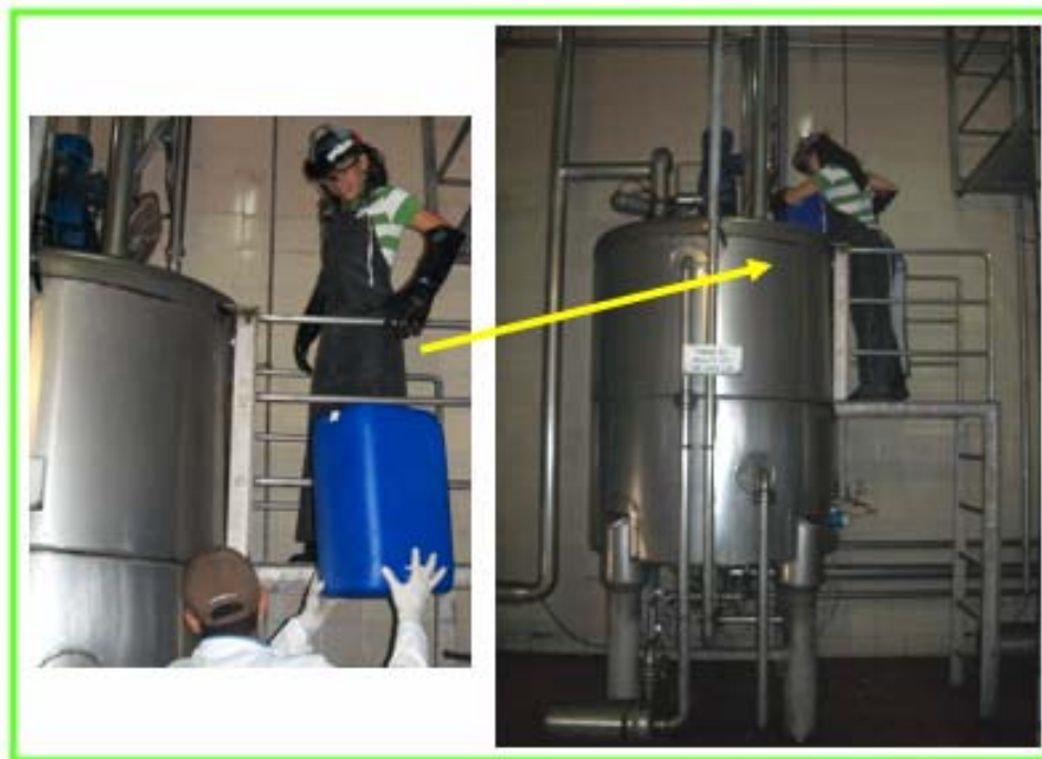
Figura 3.23. Dosificación de ácido sulfúrico en el KG1.
