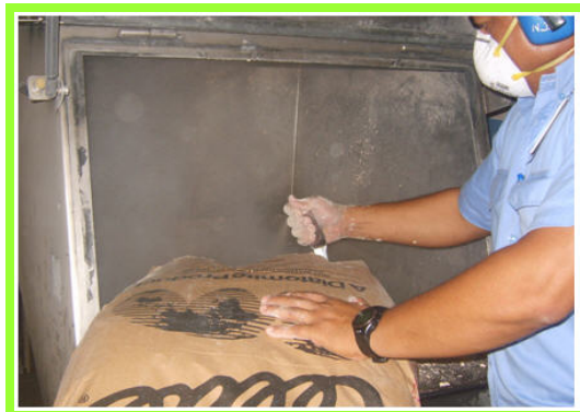
Figura 3.9. Vaciado manual de sacos de tierra infusoria en la estación.
