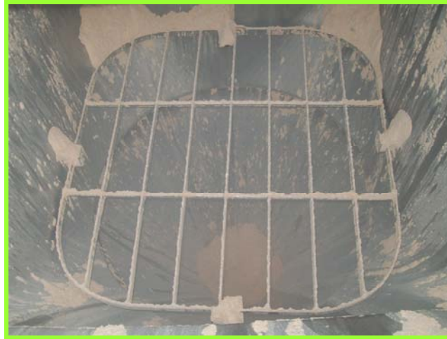
Figura 3.14. Tamiz actual en la entrada de la esclusa.
