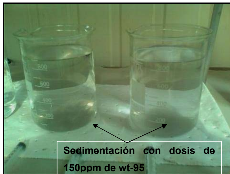
Figura 3.17 Corte de la jarra con 150 ppm de WT-95.
