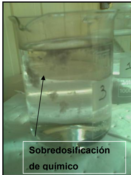
Figura 3.18 Muestra de jarra con 300 ppm de coagulante WT-95.
