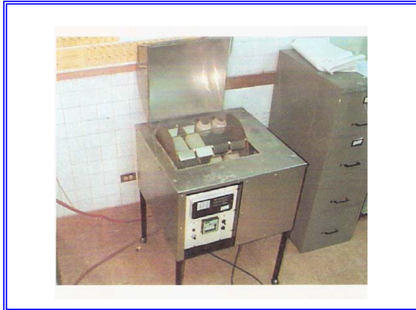
Figura 3.2 Vista lateral del equipo que simula el proceso de precipitación de C.V.G BAUXILUM
