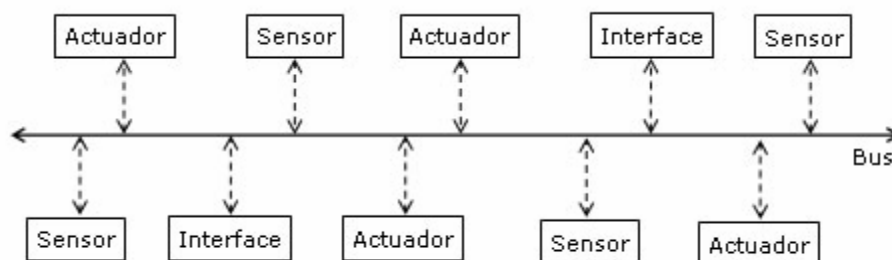
Figura 2. 5. Esquema de Arquitectura de Sistema Domótica Distribuida Fuente. (CASADOMO.com, Sin fecha de publicación)
