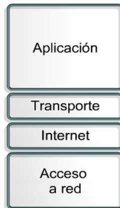
Figura 2. 12. Capas del Modelo TCP/IP Fuente. (cisco.netacad.net, 2002)
