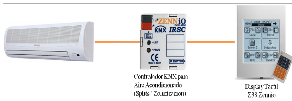
Figura 5. 24. Esquema de Climatización – Sala/Habitación Fuente. Elaboración Propia
