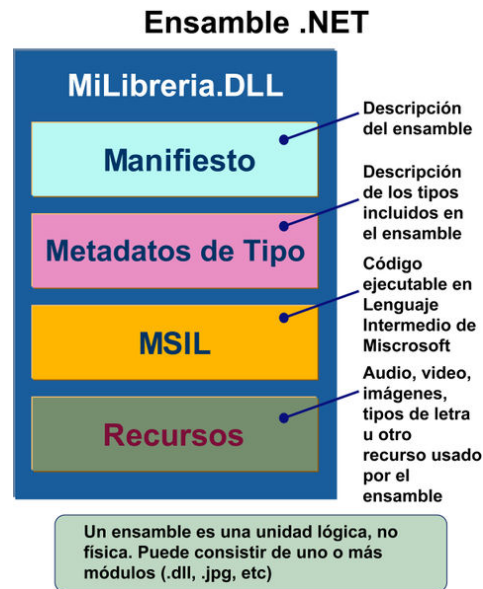
FIGURA 2.2: Diagrama interno de un Ensamble .NET
