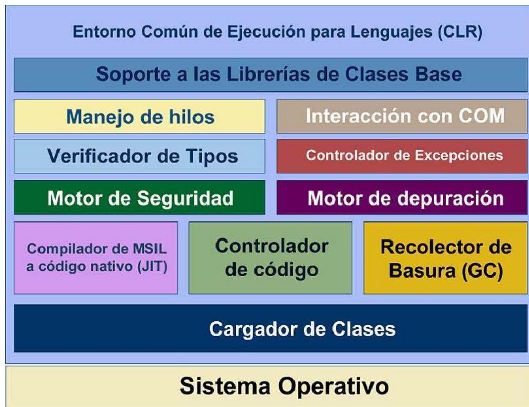
FIGURA 2.1: Estructura interna del entorno de ejecución en lenguaje común
