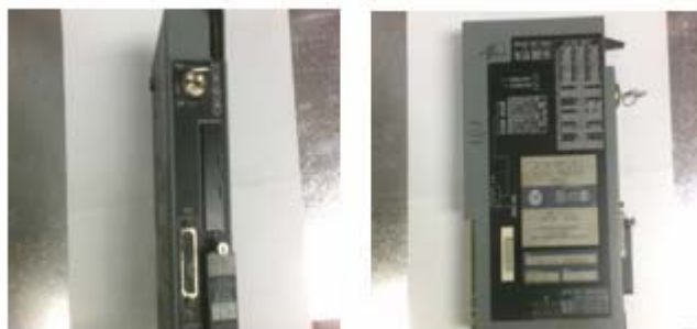
Figura N° 4.9: Vista Frontal y Lateral del PLC-5/30
