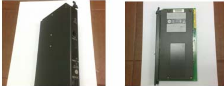
Figura N° 4.10: Vista Frontal y Lateral de Fuente de Alimentación PLC-5
