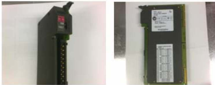
Figura N° 4.11: Vista Frontal y Lateral del Módulo de Entrada Analógica 1771-IFE/C
