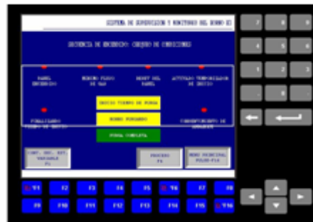
Figura N° 4.40: Pantalla de Secuencia de Encendido (Chequeo de Condiciones).
