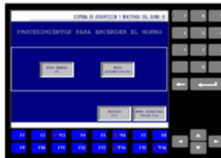
Figura N° 4.41: Pantalla de Procedimientos para encender el Horno. Fuente: Escalona R., J (2008)
