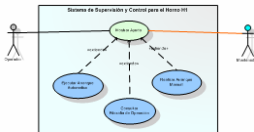
Figura N° 4.29: Diagrama Detallado del Caso de Uso Principal Mostrar Ayuda.
