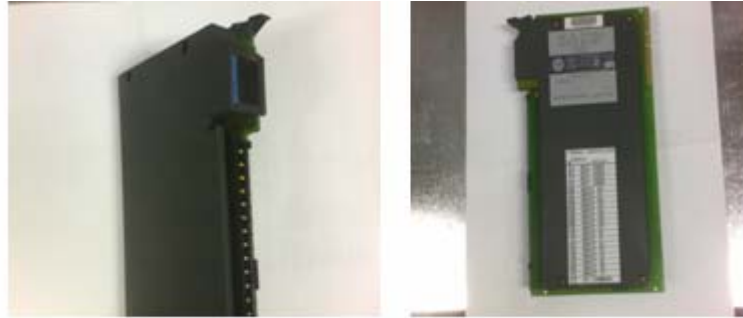
Figura N° 4.12: Vista Frontal y Lateral del Módulo de Entrada Discreta 1771-IBD
