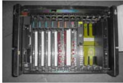
Figura N° 3.1: Vista Frontal del Controlador Lógico Programable PLC 5/30.
