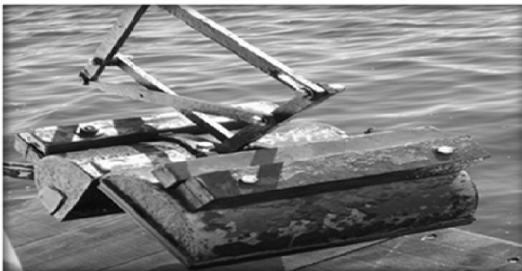
Figura 2. Draga Petersen para la toma de sedimentos marinos superficiales.
