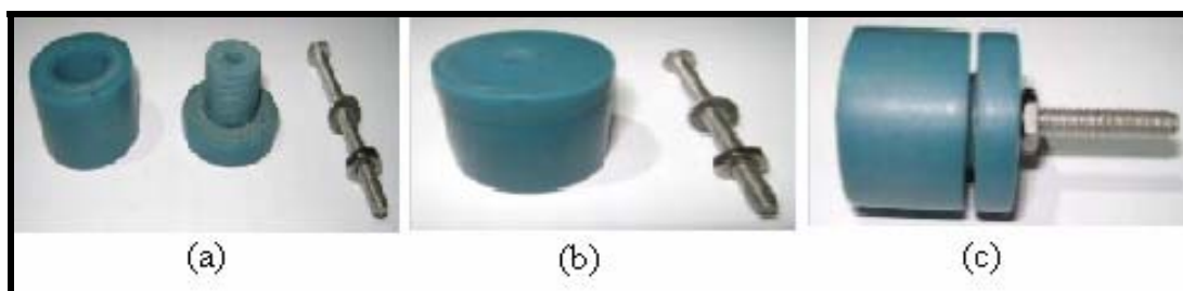
Figura 3. Sujetadores para los bastidores: (a) piezas que conforman el sujetador, (b) pieza de resina armada y (c) sujetador ensamblado.
