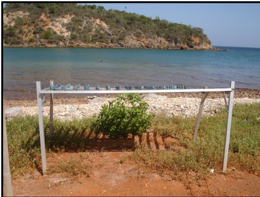
Figura 5. Instalación del bastidor para la zona atmosférica según la norma ASTM G50-76
