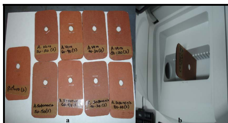
Figura 7. Diseño de portamuestras, a) películas del material en el portamuestras y b) portamuestras en el equipo
