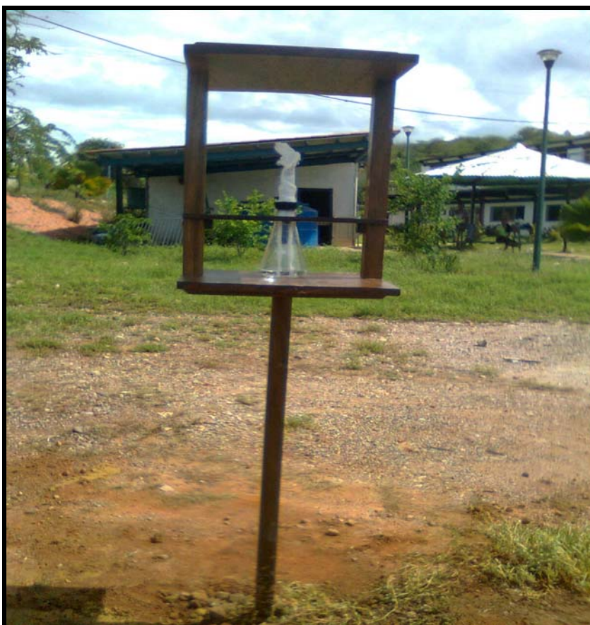
Figura 6. Método de la vela húmeda. Dispositivo para la captación de cloruros en la atmósfera.
