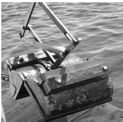
Figura 2. Draga Petersen para la recolección de sedimentos superficiales.
