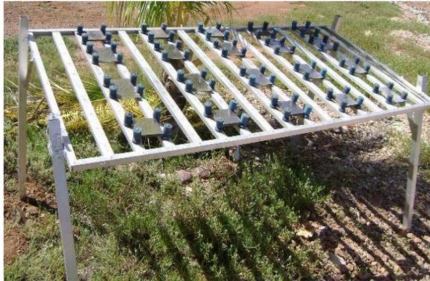
Figura 10. Instalación del bastidor para la zona atmosférica según la norma ASTM G50-76.
