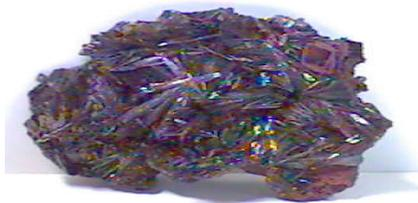
Figura 2. Goethita ( $\text{Fe}_2\text{O}_3\text{H}_2\text{O}$  también conocida como  $\alpha\text{-FeO(OH)}$ ).
