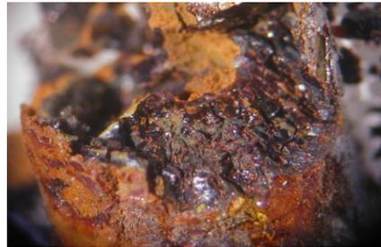
Figura 4. Ferrihidrita (Composición exacta indeterminada pero con núcleo dominante de  $\text{FeOOH}$ ).
