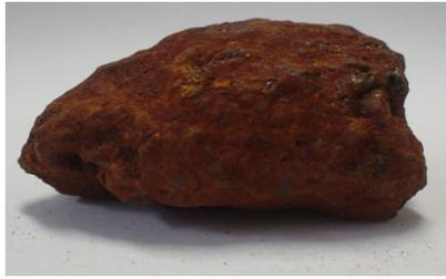
Figura 1. Hematita ( $\text{Fe}_2\text{O}_3$ ).
