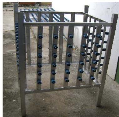
Figura 12. Bastidor para zona de inmersión según la norma ASTM G50-76.
