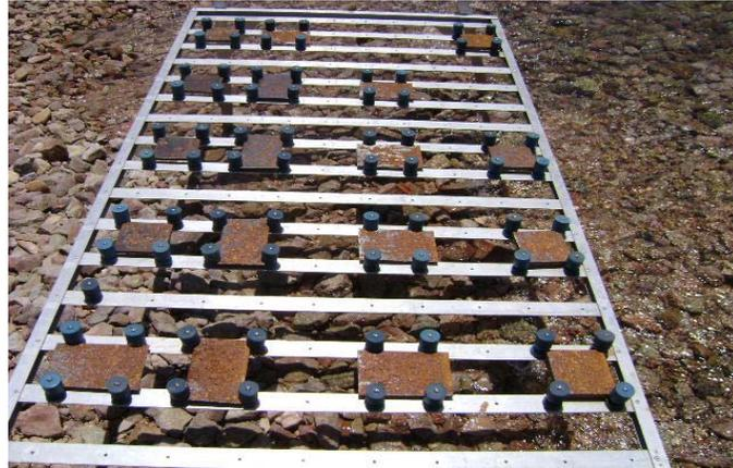
Figura 11. Instalación del bastidor para la zona de salpicado según la norma ASTM G50-76.
