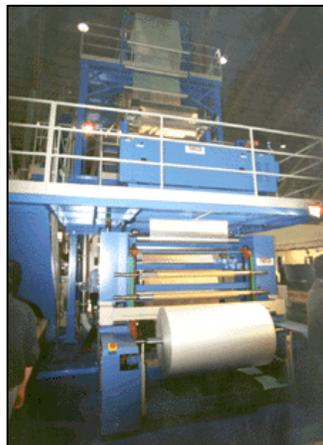
Figura 3. Extrusora de películas planas.
