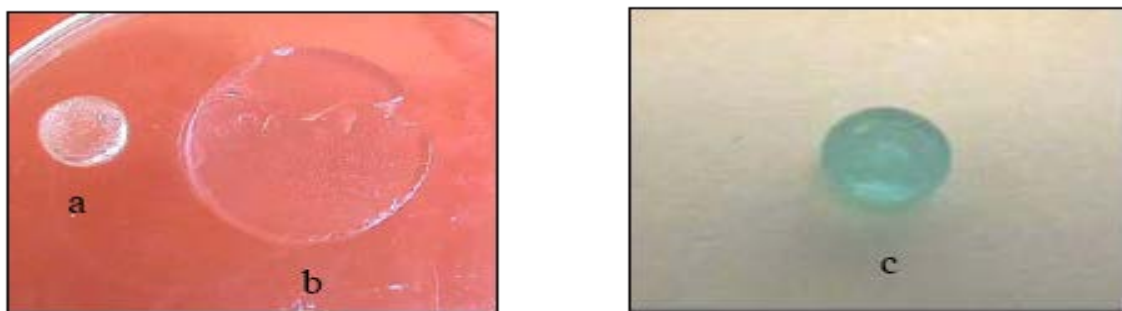
Figura 1. Fotografías de la pastilla de hidrogel (a) en estado seco, (b) hidratada y fracturada, (c) después de haber permanecido en la solución de cobre.
