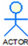
Figura 2.4. Icono del lenguaje UML que representa a un actor de casos de uso.
