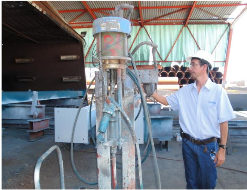
Fig. 13. Equipo para pintura por atomizado sin aire. Planta COMMETASA
