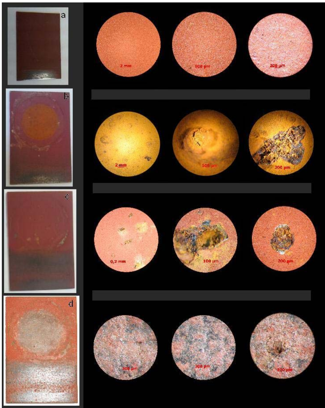
Fig. 72. Probeta Fondo alquídico y cepillado en los distintos estadios del ensayo. a) Antes del ensayo, b) Posterior al ensayo, c) Una vez retirados los productos de corrosión empleando una solución de HCl al 20%, d) Una vez retirado el recubrimiento con un removedor de pintura comercial.
