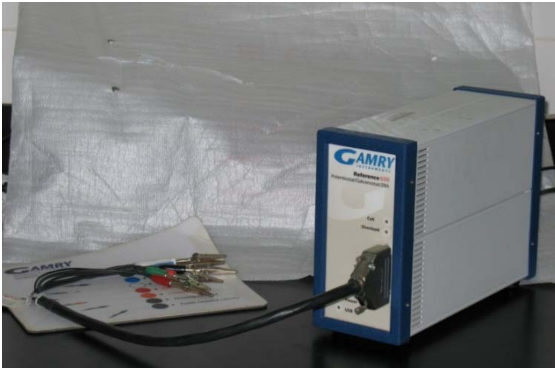
Fig. 15. Potenciostato Gamry Reference 600 S/N 04080. Laboratorio de Corrosión, IIBCAUDO.
