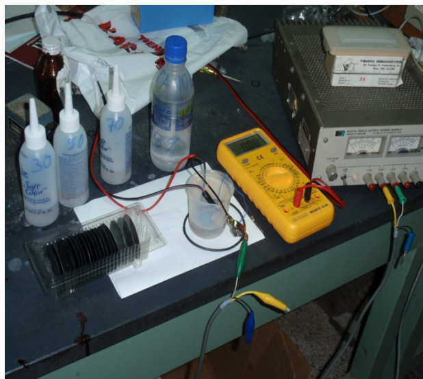
Ilustración 23. Diagrama de la celda electrolítica de HF.
