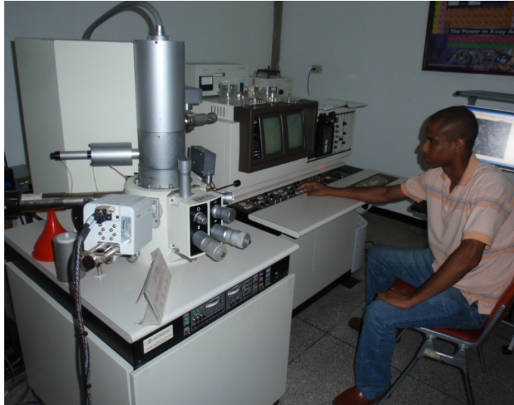
Ilustración 25. Microscopio de barrido de emisión de campo marca HITACHI modelo S-800 que se encuentra en el IIBCA.
