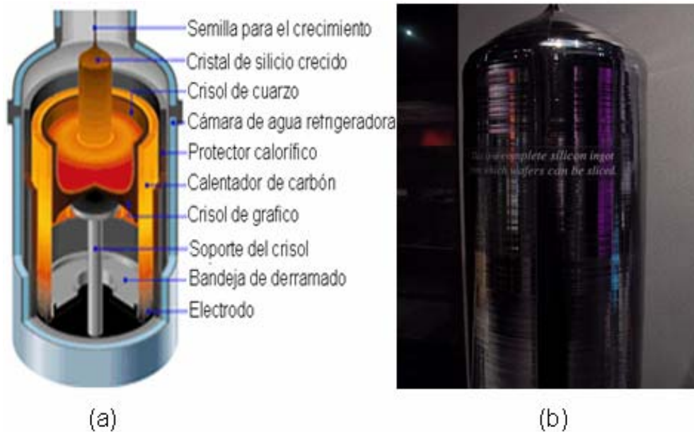
Ilustración 5. (a) El método de Czochralski y (b) lingotes de silicio cristalino.
