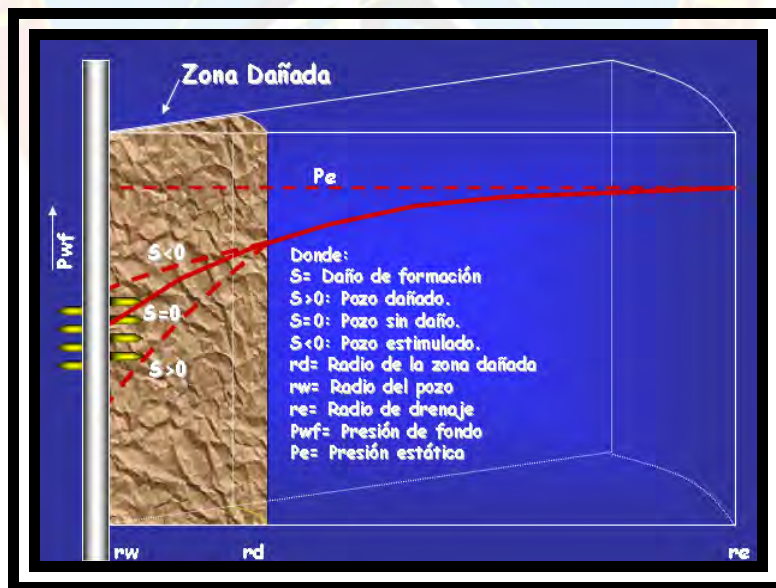
Figura 2.2 Perfil de Presión de un Pozo
