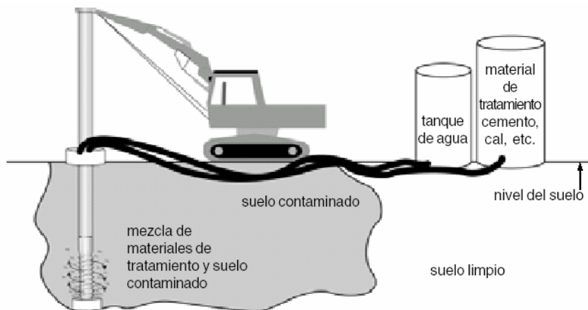
Figura 7. Proceso de estabilización/solidificación
