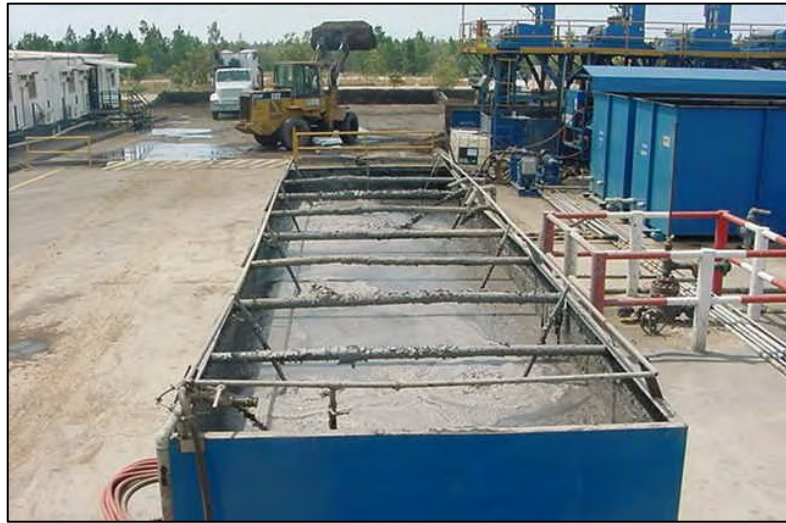
Foto 5. “Catch Tank”, tanque para disposición de lodos para ser llevados a la unidad de Dewatering
