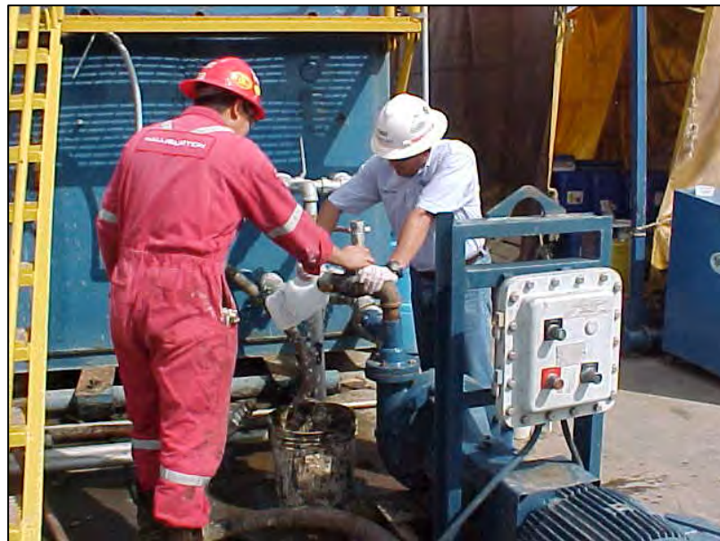
Foto 6. Recolección de agua proveniente del Dewatering para muestreo
