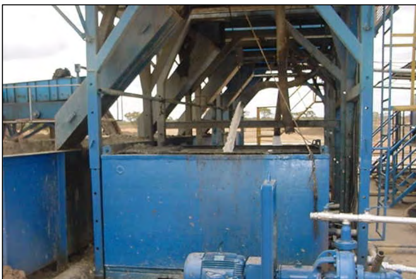
Foto 3. Recepción de la fracción sólida obtenida del Dewatering
