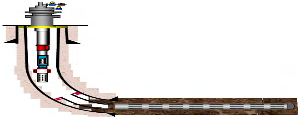
Figura 2.9 Esquema General de un Pozo Horizontal.
