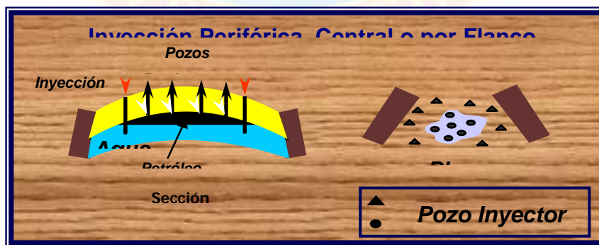
Figura N° 2.5. Inyección en Yacimiento Anticlinal con Acuífero.
