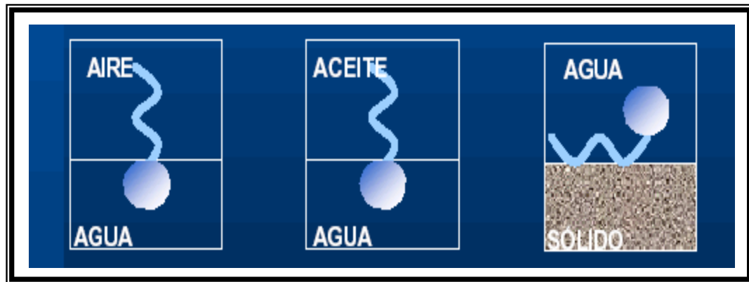
Figura 4.3. Adsorción del Surfactante en diferentes interfases. (Fuente: Simulación computacional del proceso de ASP. Fundamentos de ASP, Universidad del Zulia).
