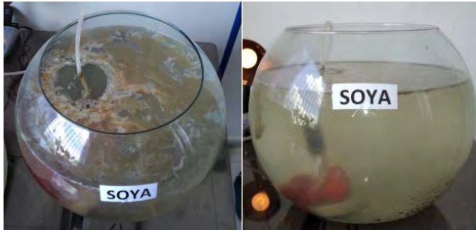
Figura N° 4.4. Características visuales del ecosistema contaminado con el fluido de perforación base aceite soya.
