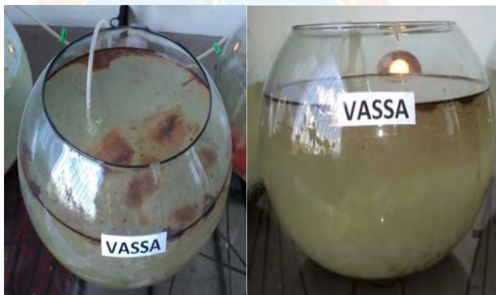
Figura N° 4.3. Características visuales del ecosistema contaminado con el fluido de perforación base aceite vassa.
