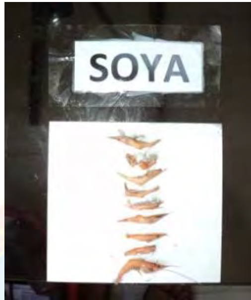
Figura E.25. Camarones ( Caridina multidentata ) muertos, por el fluido de perforación base aceite soya.
