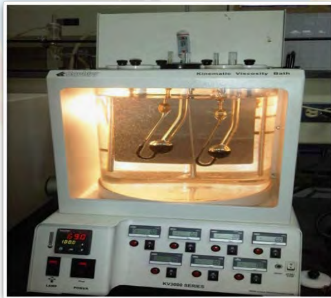
Figura C.2.2. Capilares en el viscosímetro x, incrementándole la temperatura.
