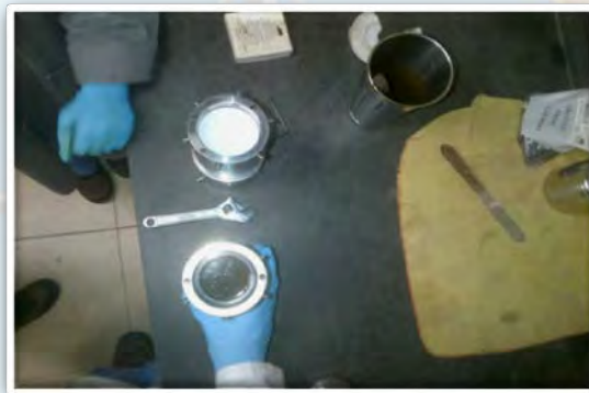
Figura C.7.8 Montado el fluido en estudio dentro del filtro AP-AT.
