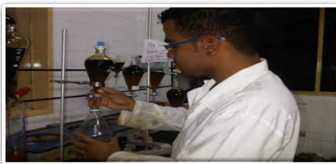
Figura C.3.6. Tesista Anderson Hernández separando la mezcla de los líquidos (Aceite, alcohol y n-heptano)
