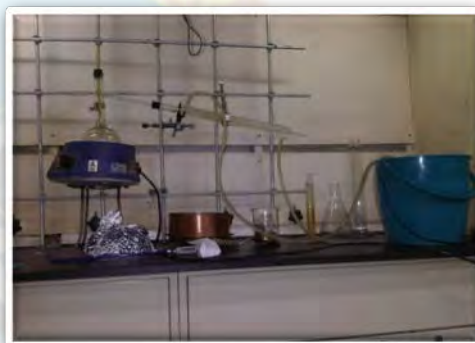
Figuras C.3.12 y C.3.13. Ejecución del proceso de destilación atmosférica al aceite filtrado por el empaque.
