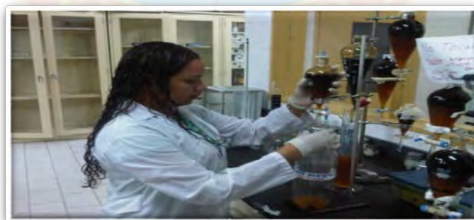
Figuras C.3.5. Tesista Milagros Caraballo ejecutando la separación de los líquidos (Aceite y alcohol)
