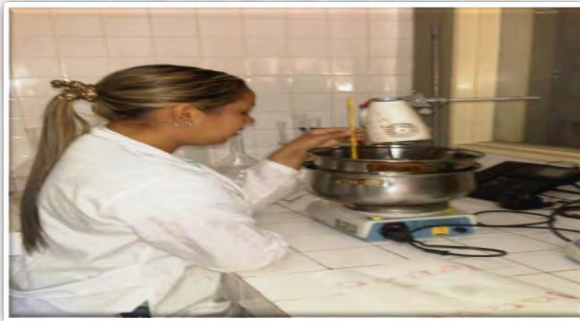
Figura C.5.2. Tesista Milagros Caraballo midiendo la temperatura durante la preparación del biodiesel.
