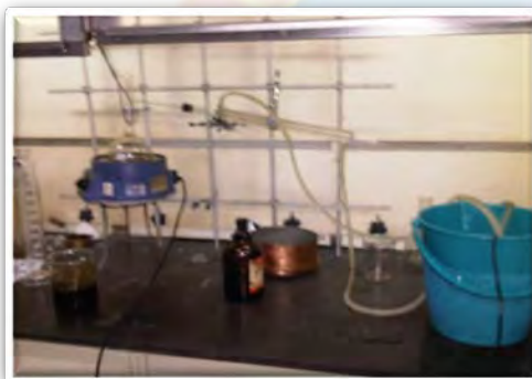
Figuras C.3.12 y C.3.13. Ejecución del proceso de destilación atmosférica al aceite filtrado por el empaque.
