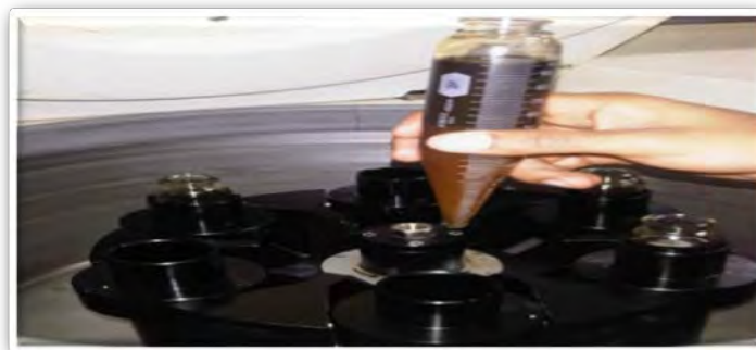
Figura C.3.3. Probeta con la separación de los líquidos (aceite de motor original y alcohol isopropílico)
