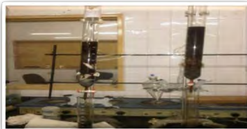
Figuras C.3.10 y C.3.11. Filtrando el aceite decantado a través de los empaques elaborados.
