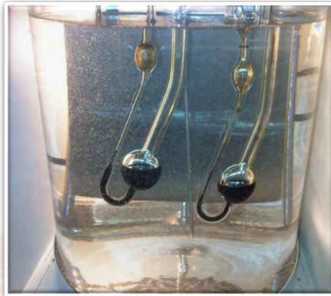
Figura C.2.1 Capilares en el viscosímetro x para la posterior determinación de la viscosidad cinemática del aceite recuperado de motor.
