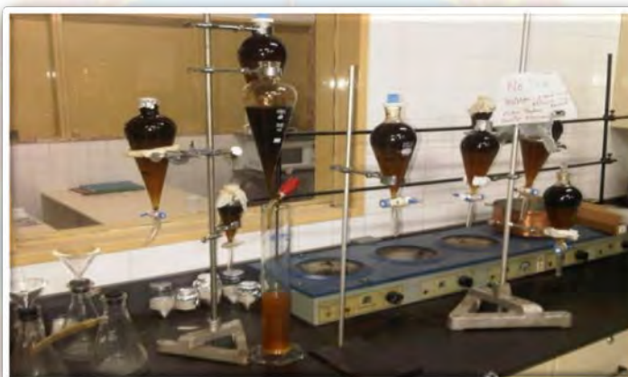
Figura C.3.4. Decantación de la mezcla de aceite de motor original y alcohol.
