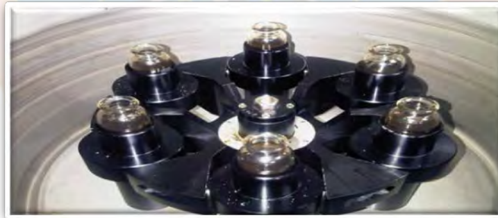
Figura C.3.2. Centrífuga preparada para la agitación del aceite de motor original y el alcohol
