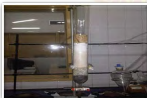
Figuras C.3.8 Y C.3.9. Empaques elaborados para la limpieza del aceite de motor decantado.
