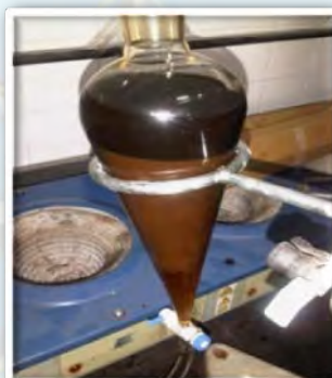
Figura C.3.7 decantación de la mezcla de alcohol isopropílico,aceite de motor y n-heptano.
