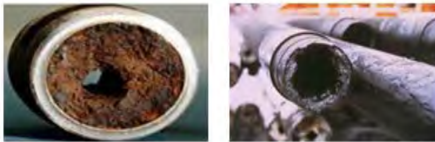
Figura 2.4 Obstrucción de tuberías por deposición de asfaltenos. Fuente: Oliffield Review
