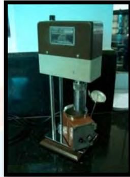
**Figura C.4.3. Viscosímetro rotacional OFITE 800**
