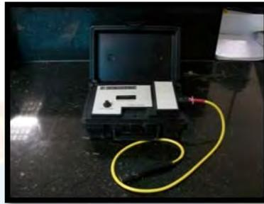
**Figura C.4.5 Equipo medidor de estabilidad eléctrica**
