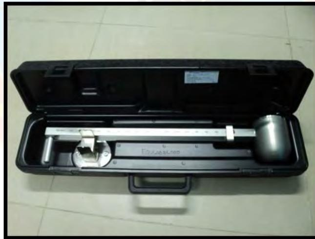
**Figura C.4.2. Balanza de fluido OFITE**
