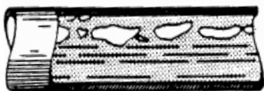
**Flujo Tipo Burbuja:** El líquido ocupa el volumen de la sección transversal y el flujo de gas forma burbujas a lo largo del tope de la tubería. Las velocidades del gas y el líquido son aproximadamente iguales. Si las burbujas tienden a dispersarse a través del líquido, esto se llama algunas veces flujo tipo espuma.
