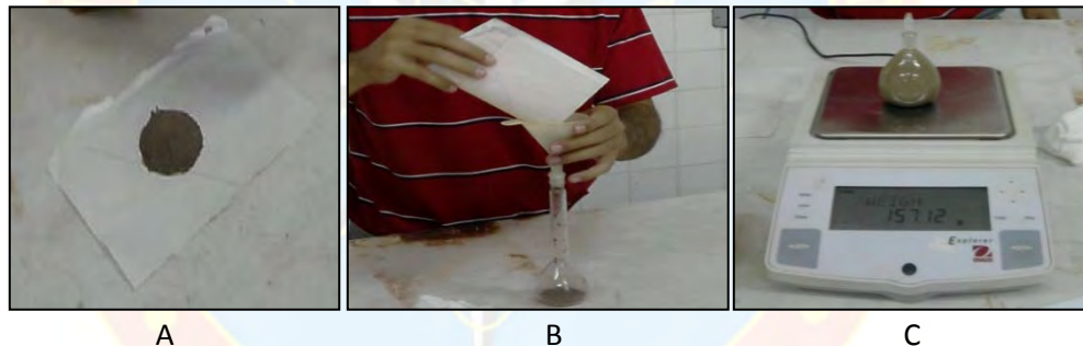
Figura 8. Muestra los pasos para la Determinación de la Gravedad Específica con el Método de Agua. (La figura A indica el pesado de la muestra del suelo, la figura B indica el proceso de introducción de la muestra de suelo al picnómetro y la figura C, el pesado de la muestra una vez calentada y sacado el aire del suelo).
