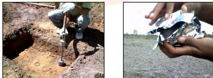
Figura 6. Abertura de la Calicata y Recolección de la Muestra.
