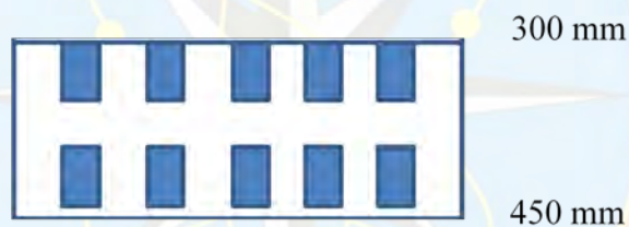
Figura 5. Posición de los Cilindros para la Toma de las Muestras en las Calicatas.
