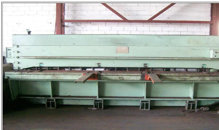
Figura C.4 Cortadora de lámina 5mm.
