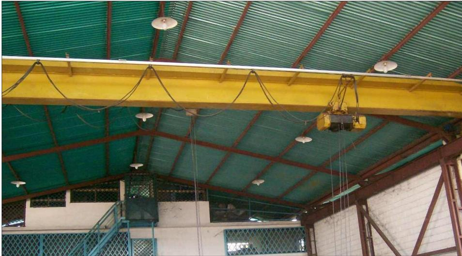
Figura C.2 Puente grúa 5 Ton.
