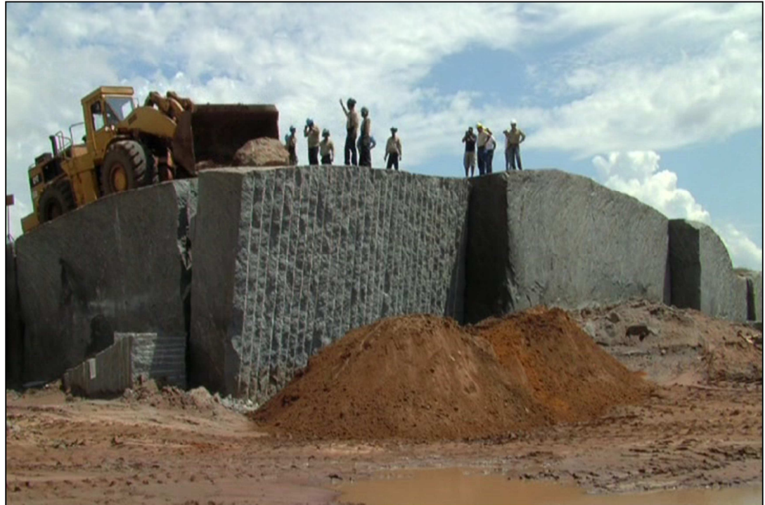
Figura 5.10 Técnica utilizada para liberar el planchón de granito (EXPIGUA, Cantera la Leona 2010)
