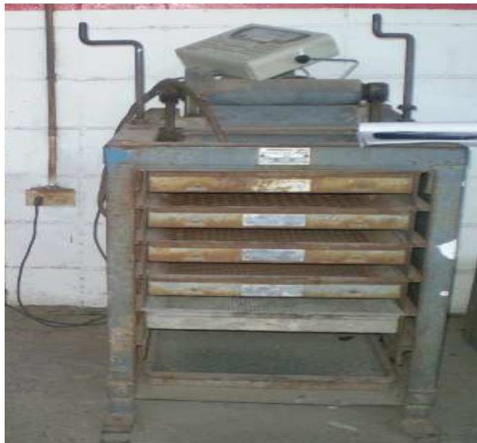
A.4 Maquina Tamizadora para agregado grueso.
