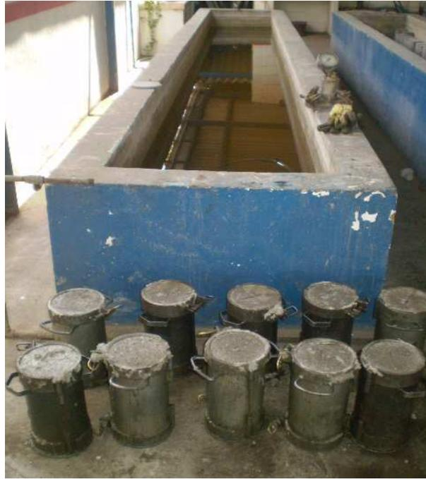
C.7 Cilindros vaciados listos para el curado
