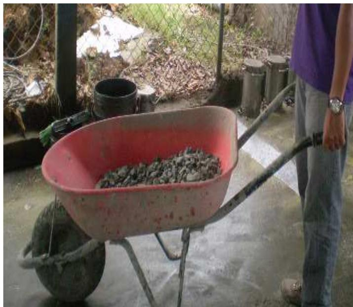
A.12 Carretilla para transporte de mezcla y agregados
