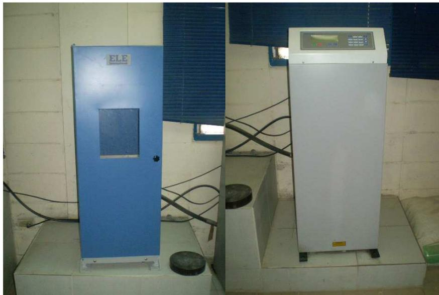
A.6 Prensa hidráulica electrónica para ensayo a la compresión
