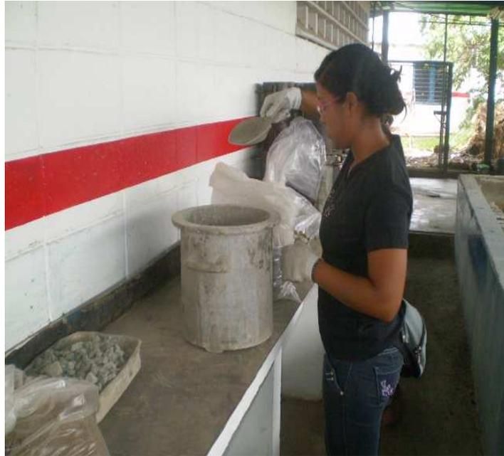
B.5 Ensayo de peso unitario agregado fino
