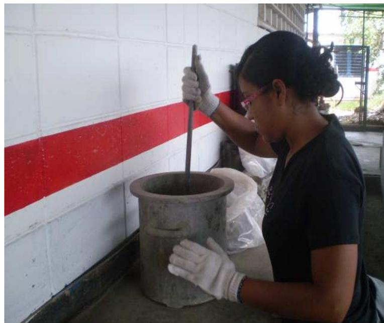
B.6 Compactación de la muestra para ensayo de peso unitario
