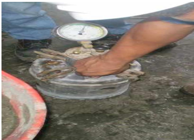
A.8 Equipo Humbolt para ensayo de contenido de aire
