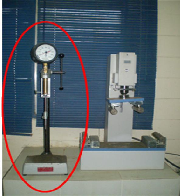
A.5 Equipo para ensayo a la penetración
