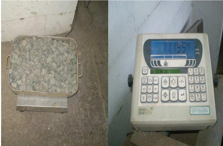
A.3 Balanza electrónica de capacidad 30 Kg.
