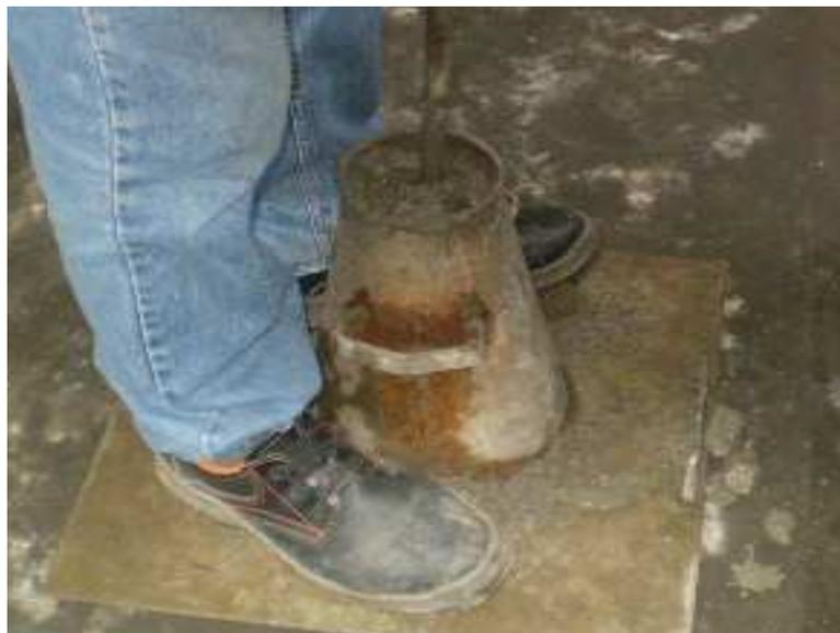
A.10 Cono de abrams para ensayo de asentamiento
