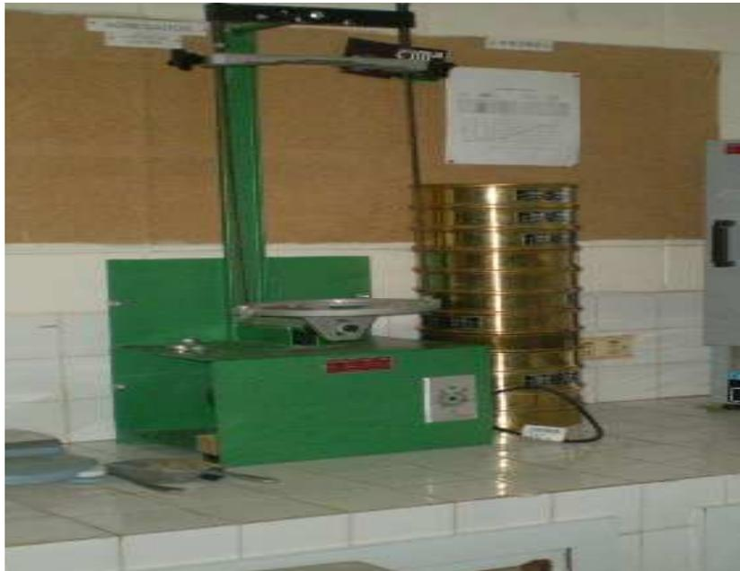
A.7 Tamizadora eléctrica para agregado fino
