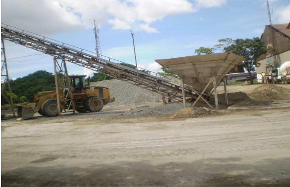
D.3 Proceso de traslado a través de cinta transportadora de agregado fino y grueso
