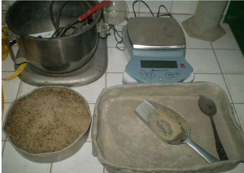
B.1 Muestra de agregado fino para ensayo granulométrico
