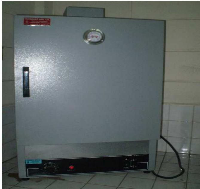
A.1 Horno para secado de muestras de agregados.
