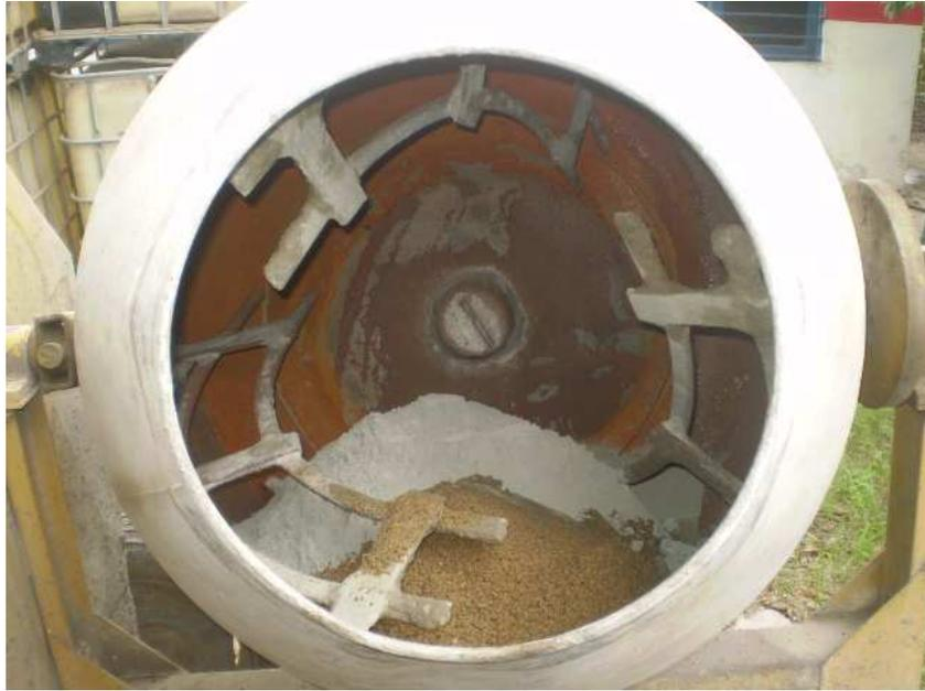
C.1 Colocación de dosificación de materiales para 35 l de muestra.
