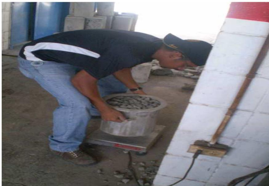
B.4 Tarado de agregado grueso para ensayo de peso unitario
