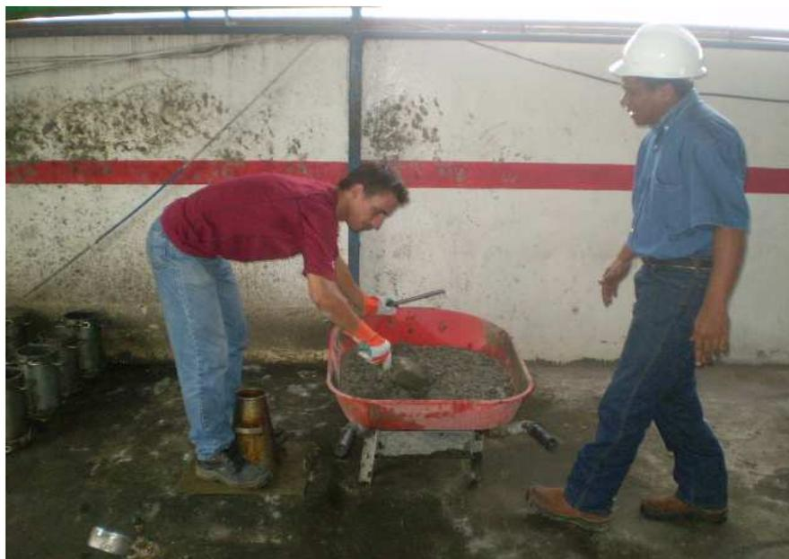
C.4 Realización de ensayo de asentamiento mediante cono de Abrams
