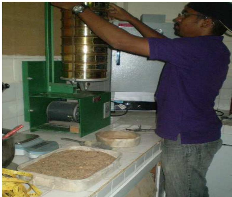
B.2 Acople de la tapa superior y tamizado de agregado fino
