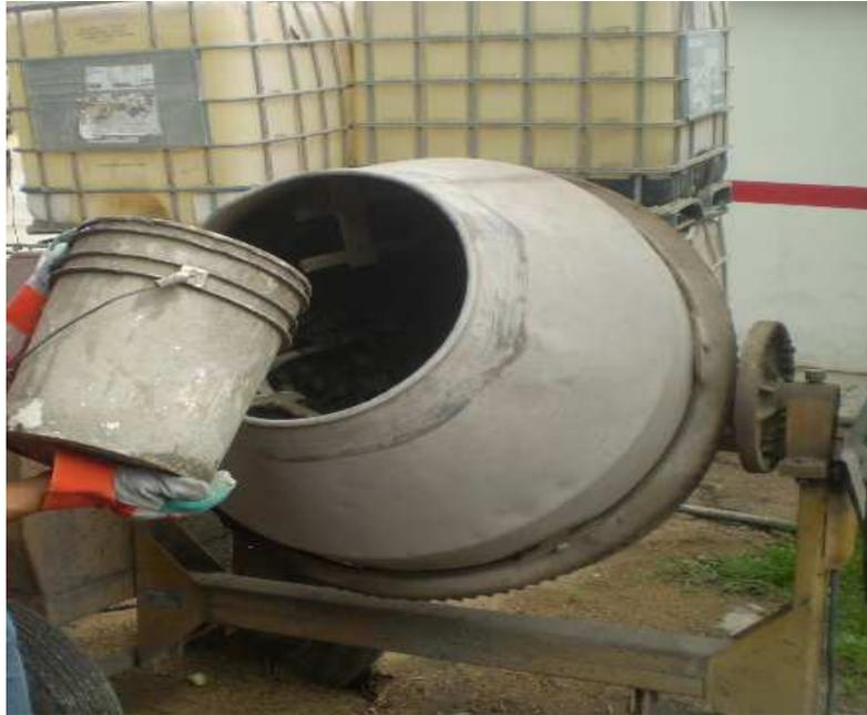
A.9 Trompo mezclador para muestras de concreto
