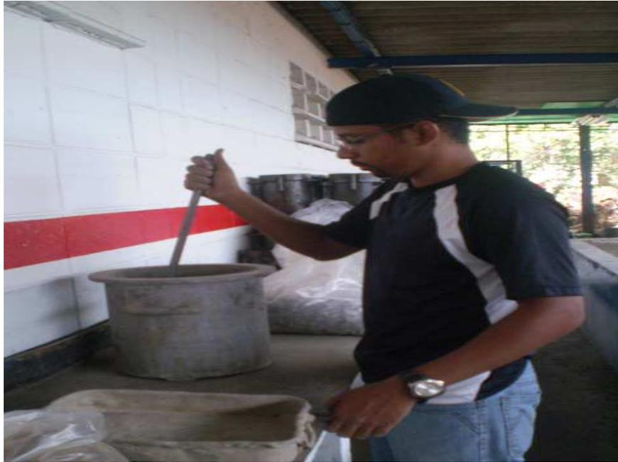
B.3 Ensayo de peso unitario Agregado grueso
