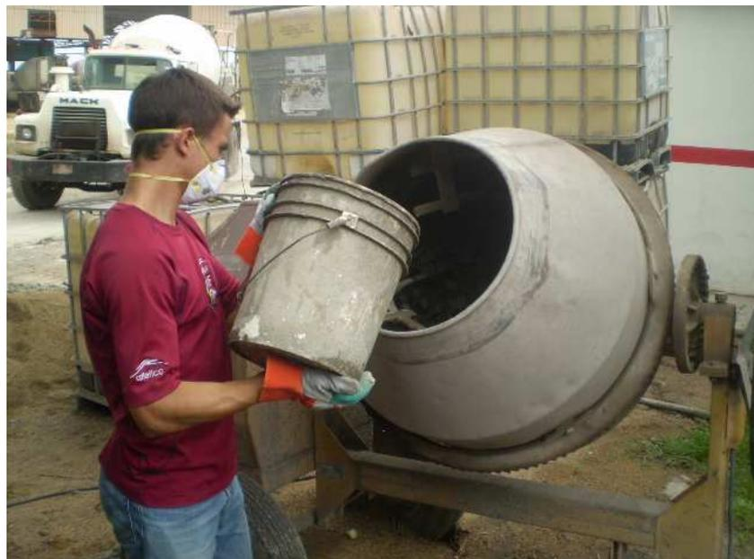
C.2 Adición de agua y aditivo al muestra para mezclad.
