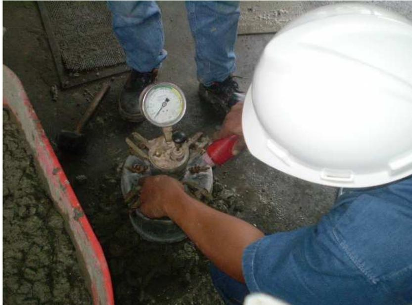
C.5 Determinación de contenido de aire de la muestra
