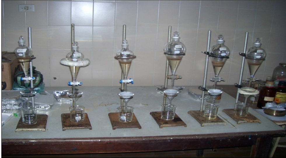
Figura 4.2 Concentración de minerales pesados mediante el uso de bromoformo.
