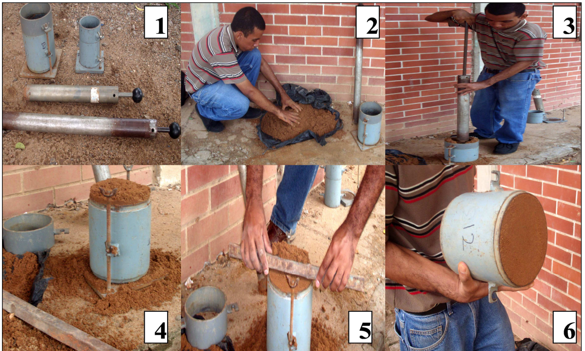
Figura 4.10 Procedimiento para el ensayo de compactación (González y Tirado, 2010).
