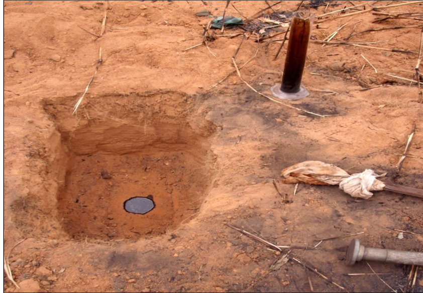
Figura 4.5 Ensayo de densidad in situ (método del aceite).
