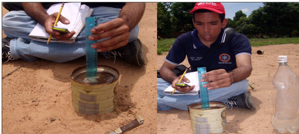
Figura 4.6 Ensayo de infiltración.
