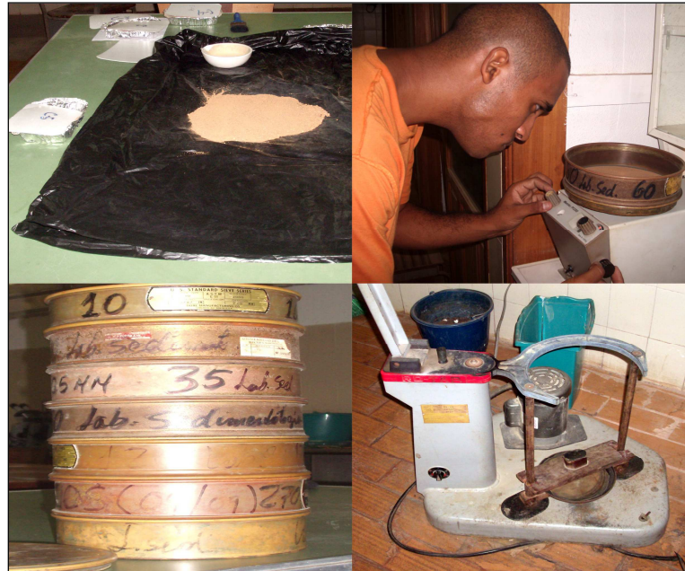
Figura 4.7 Procedimiento para el ensayo de granulometría.
