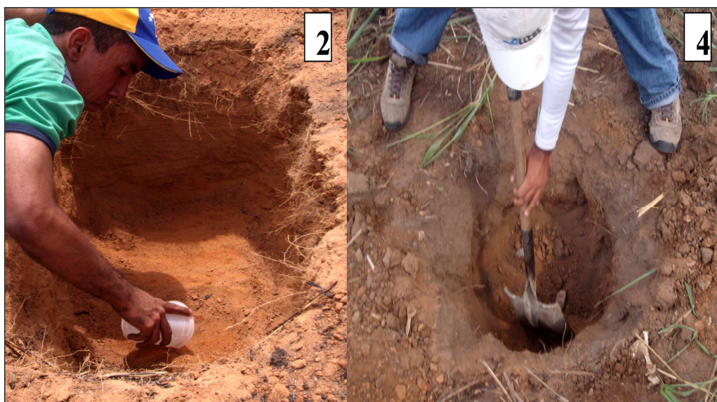
Figura 4.4 Calicatas 2 y 4 correspondientemente (González y Tirado, 2010).
