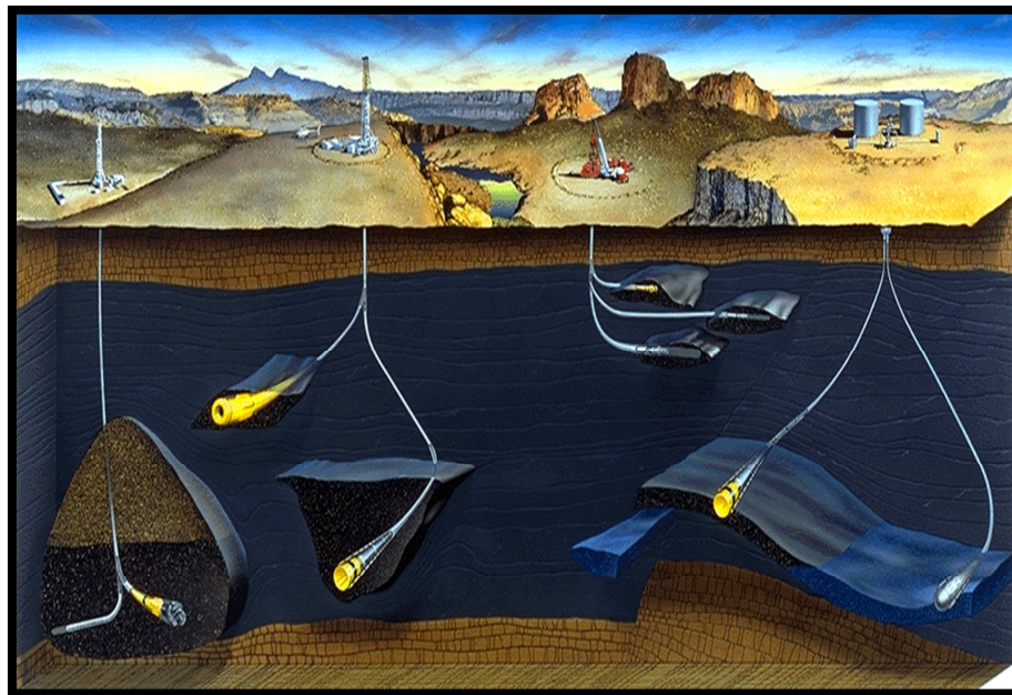
Figura 3.1 Pozos horizontales (Halliburton 2009).
