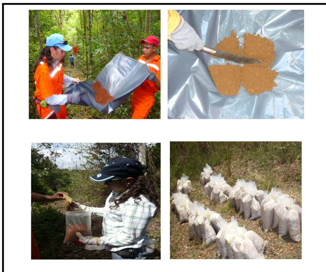
Figura 4.2 Homogenización, cuarteo, codificación y envase de las muestras.
