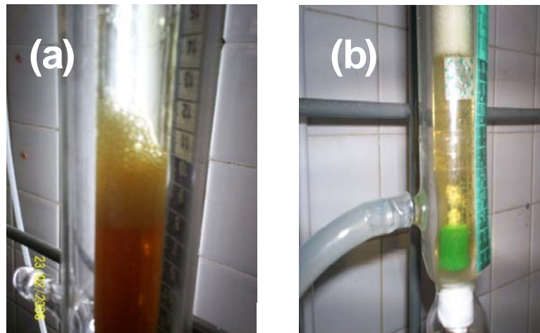
Figura 3.2 Fotografía de detalle de la parte baja de la columna: a) sistema con tela, b) sistema con inyección por la parte superior de la columna.
