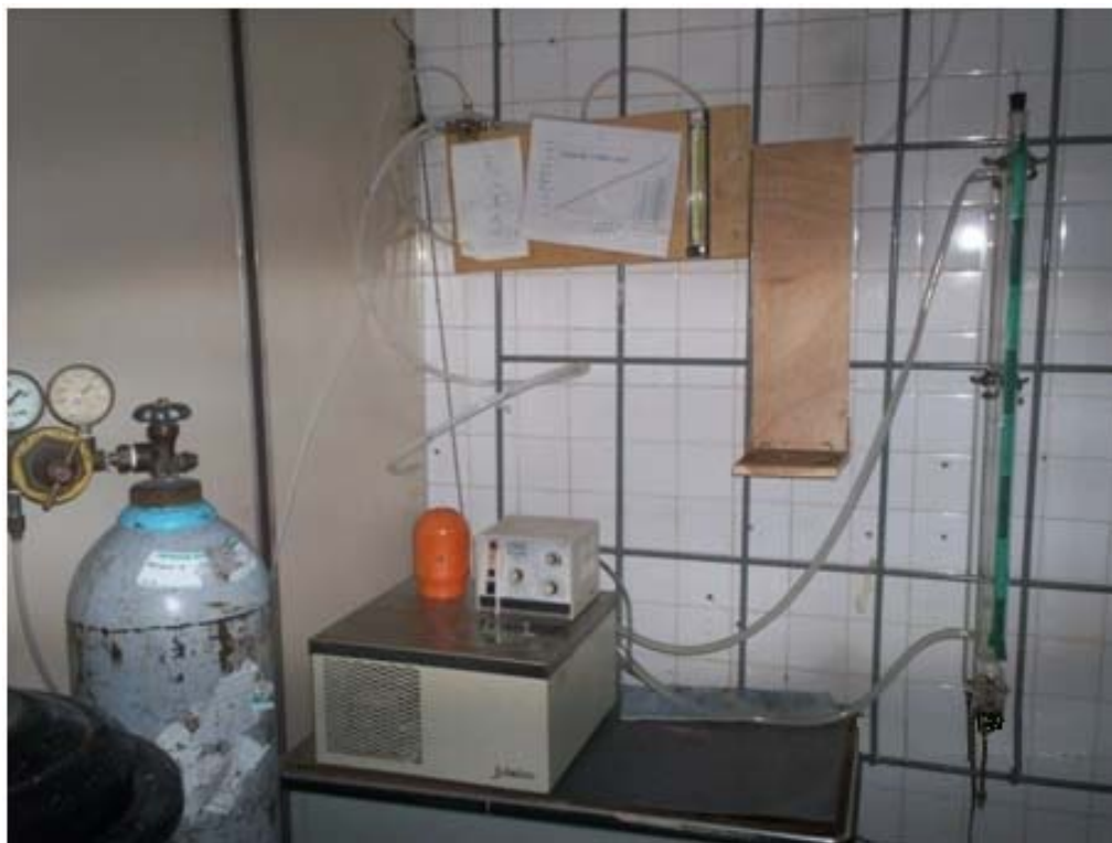
Figura 4.1 Equipo usado para la evaluación de espumas no acuosas.
