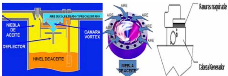
Figura N° 2.12 Esquema de la cámara vortex de aceite (tubo de Venturi) y Cabezal generador de Niebla. [6]
