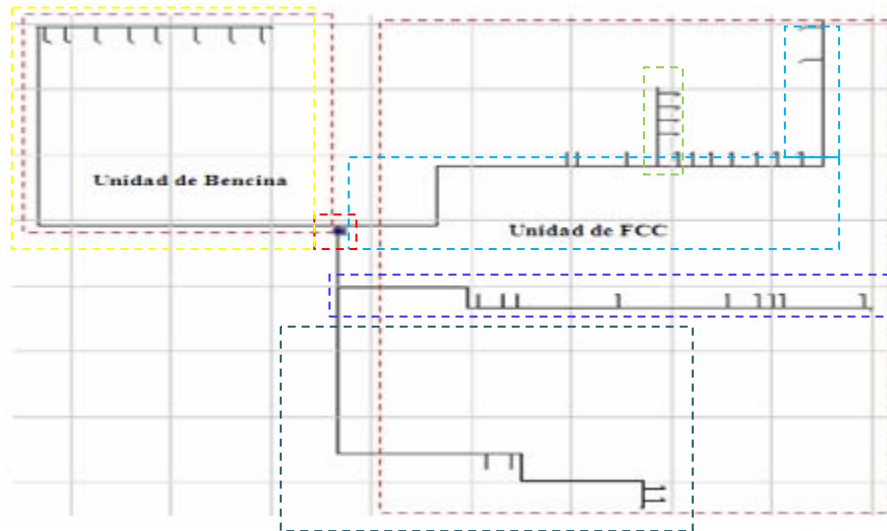
Figura N° 4.19 Red de tuberías principal para la Unidad de FCC y Bencina. Vista de planta.
