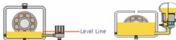
Figura N° 2.9 Ubicación correcta e incorrecta del lubricador de nivel de aceite constante. [5]
