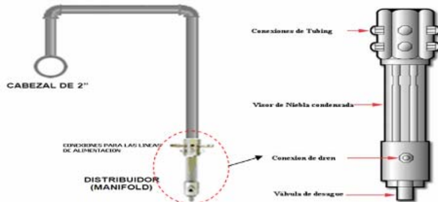
Figura N° 2.14 Tubería secundaria y distribuidor. [6]
