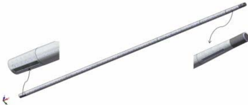
Figura.3.19. Eje de propulsión de la moto nave Gran Cacique II ampliado en sus chaveteros [Fuente propia]
