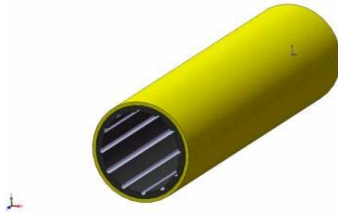
Figura 2.5. Bocina propulsora. [Fuente propia]
